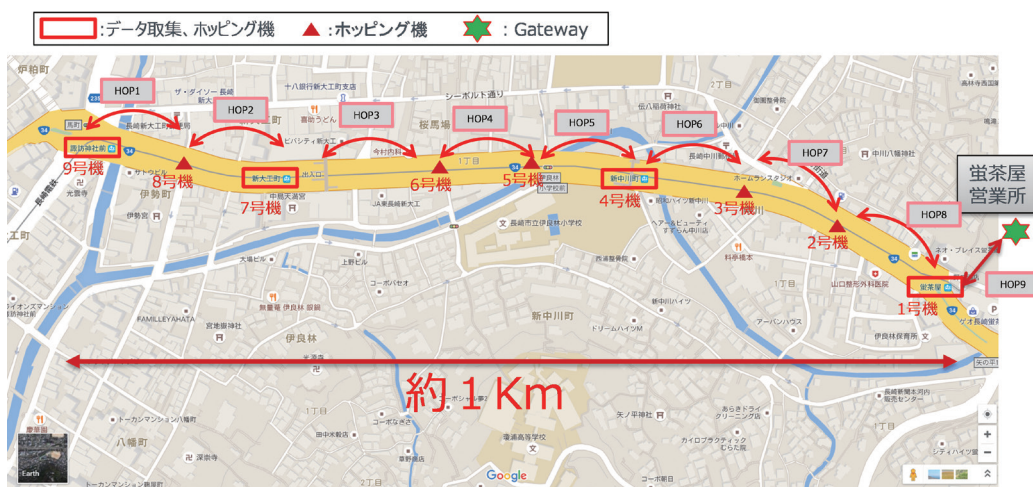
〈図2. 920MHz帯特定小電力無線によるデータホッピング実験の概念図〉
